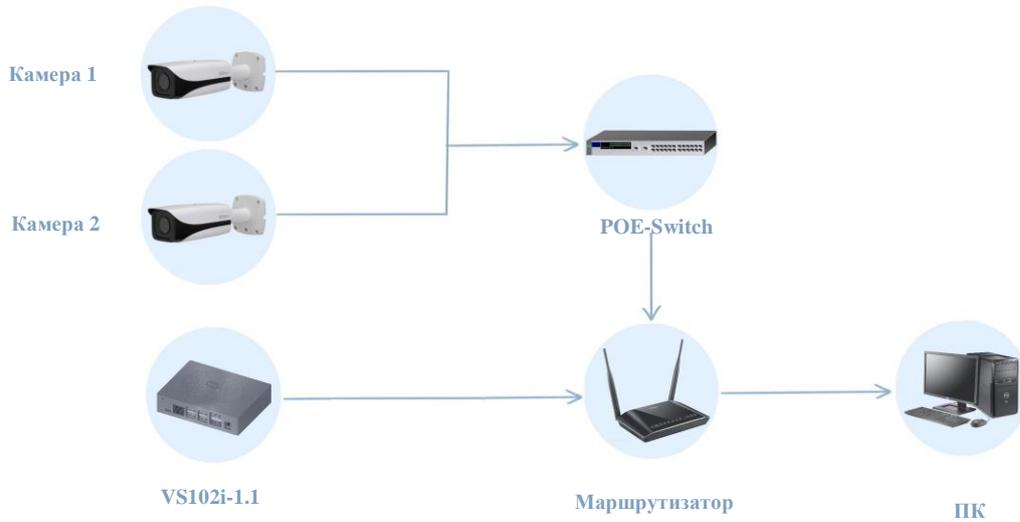
1. Подключение видеокамер патч-кордом к POE-switch.
